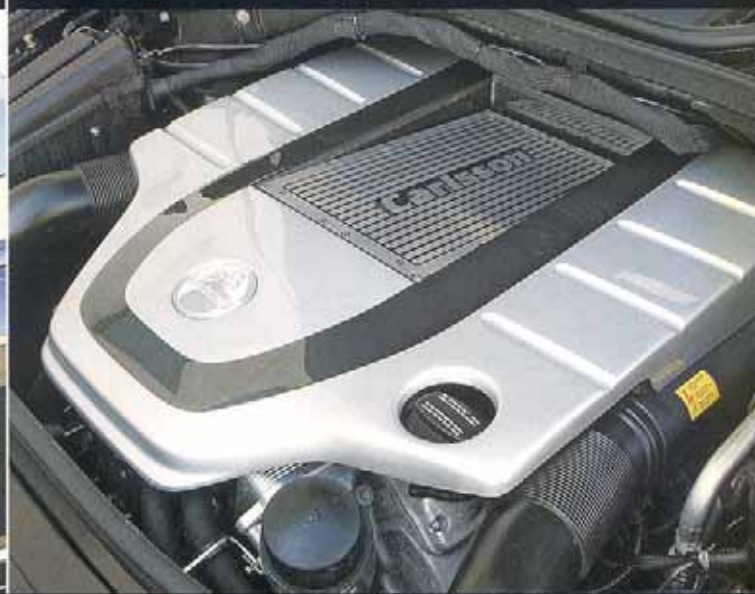
Kraftwerk: Der Carlsson-Kompressor entlockt dem V8 650 Nm Drehmoment
