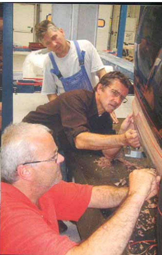
カールソンでは通常メルセデス・ベンツの風洞をレンタルしてテストする。自製したパーツの多くは風洞実験で好結果を示し、ほとんど改良する必要がない場合が多いという。エアロのプロトタイプ制作現場では、車体にクレーンを貼り付けてそのマウンティングを探る。そしてワンオフのスポイラーやサイドシルを作成した後に風洞実験が行なわれる。
