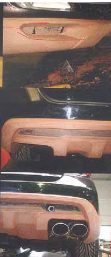
カールソンでは通常メルセデス・ベンツの風洞をレンタルしてテストする。自製したパーツの多くは風洞実験で好結果を示し、ほとんど改良する必要がない場合が多いという。エアロのプロトタイプ制作現場では、車体にクレーンを貼り付けてそのマウンティングを探る。そしてワンオフのスポイラーやサイドシルを作成した後に風洞実験が行なわれる。
