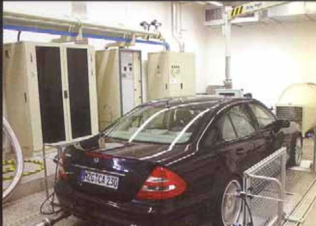
Carlsson社には最大計測馬力900psという最新式シャーンダイナモが設置されている。ドイツでは「チューニングカーはそのベースになったモデルよりも排気ガス基準値、燃費などが悪くなってはいけない」という車検上の決まりがあり、このためにシミュレーションは不可欠な結果で、Carlssonでは必要な投資は絶対に惜しまない。
