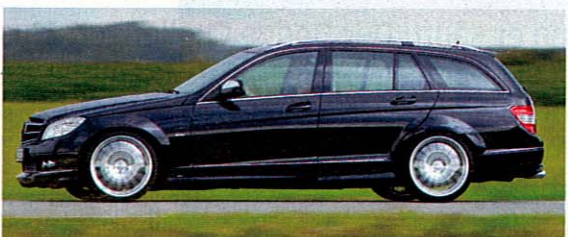
Typisch Carlsson: ultra light 8,5-mal-19"-Räder mit 225/35er-Gummis vorn und 255/30 hinten
