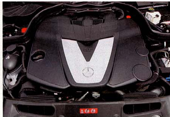
Der Dreiliter-V6 leistet 269 PS und mobilisiert 612 Newtonmeter bei 1800 Touren
